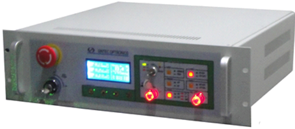
LDD-T 系列(液晶显示) 外形尺寸 482×133×520mm 净重 15kg
